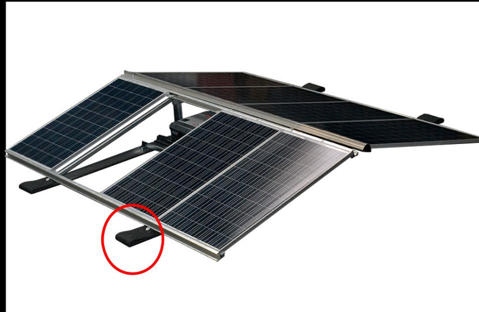
Das extra breite Bodenprofil von 20cm bewirkt eine nur geringe, partielle Flächenpressung, die durch das Montagesystem auf das Flachdach einwirkt. Somit sorgt die große effektive Auflagerfläche für eine gleichmäßige Lastverteilung und maximale Sicherheit für Dachhaut und Dämmung.
