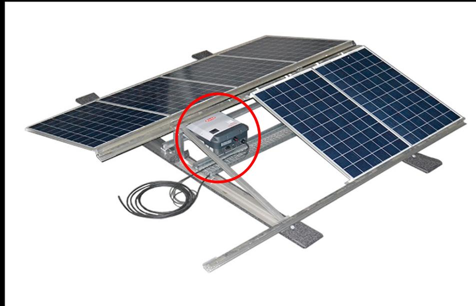
Das SOL-50 Flachdachmontagesystem DUOFLEX bietet die Option der dezentralen Wechselrichtermontage im System. So ist der Wechselrichter geschützt vor Witterung und ist dennoch gut belüftet. Dank des dezentralen Wechselrichterkonzeptes sind nur kurze Kabelwege von Nöten, die wiederum weniger Verluste mit sich bringen. Die schnelle und sichere Montage erfolgt auf einer speziell entwickelten Wechselrichterhalterung, welche auch die spätere Zugänglichkeit gewährleistet.
